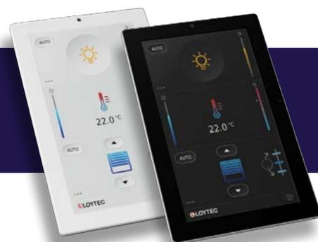
I Touch Panel LPAD-7 comunicano in Modbus come Master o Slave. A tale scopo supportano Modbus TCP e Modbus RTU/ASCII disponibile tramite la socket opzionale LPAD7-SOCKET1, LPAD7-SOCKET2, LPAD7-SOCKET3 o LPAD7-SOCKET4 con interfaccia RS-485.
